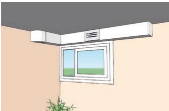
Le conduit T2A (appelé communément trainasse) peut être une solution **pratique et économique** pour ventiler une pièce technique (Cuisine / Salle de Bains / WC) non pourvue de conduit de ventilation.
